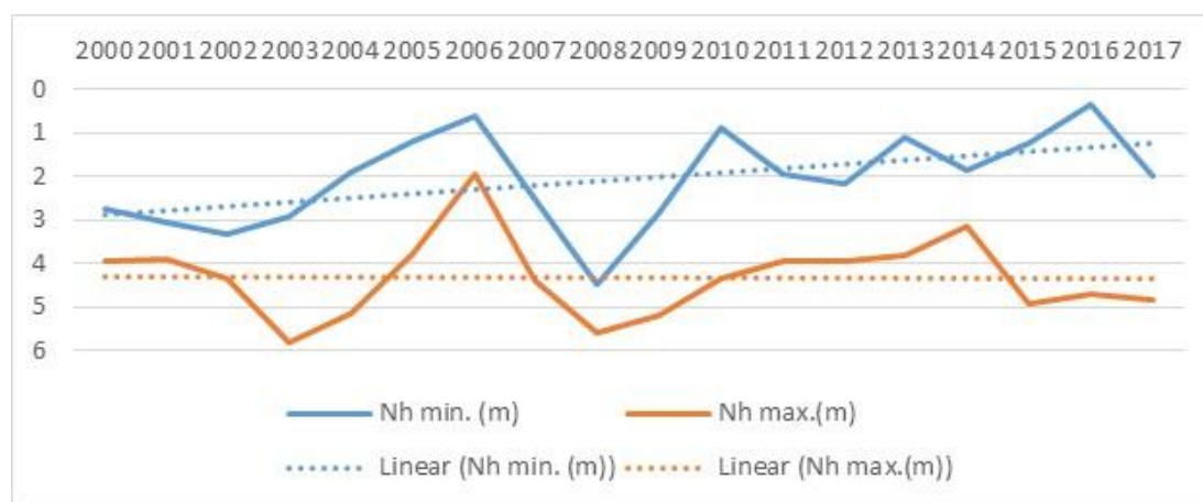
Figura 4.24 Variația adâncimii minime și maxime anuale a nivelului hidrostatic (m) măsurată față de cota terenului, în perioada 2000-2017 în forajul F1 Modelu situat la aproximativ 50 m distanță de situl ROSCI0022 corpul de apă subterană ROIL11
