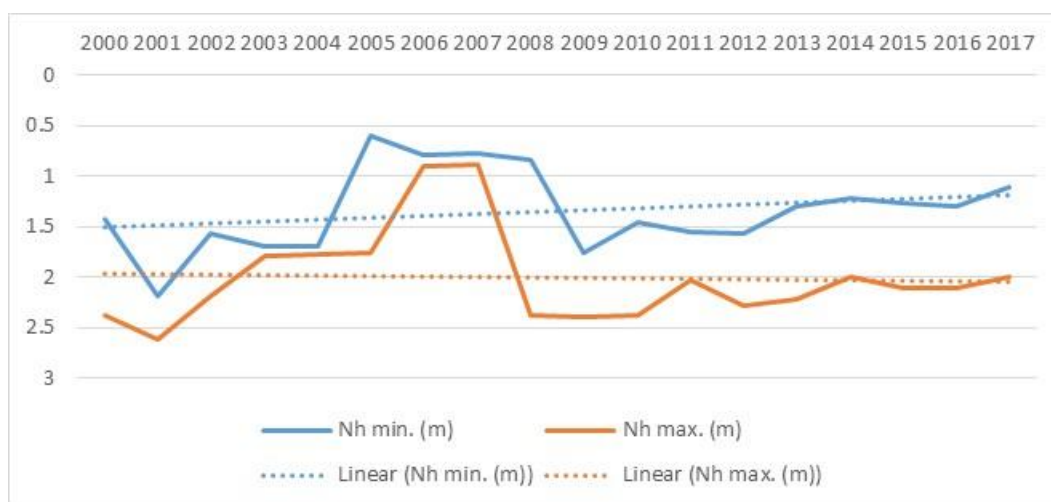
Figura 4.7 Variația adâncimii minimă și maximă anuală a nivelului hidrostatic (m) măsurată față de cota terenului, în perioada 2000 - 2017, în forajul F1 Maxenu Sud ord.II situat în apropierea sitului ROSCI0259, corpul de apă subterană ROIL05
