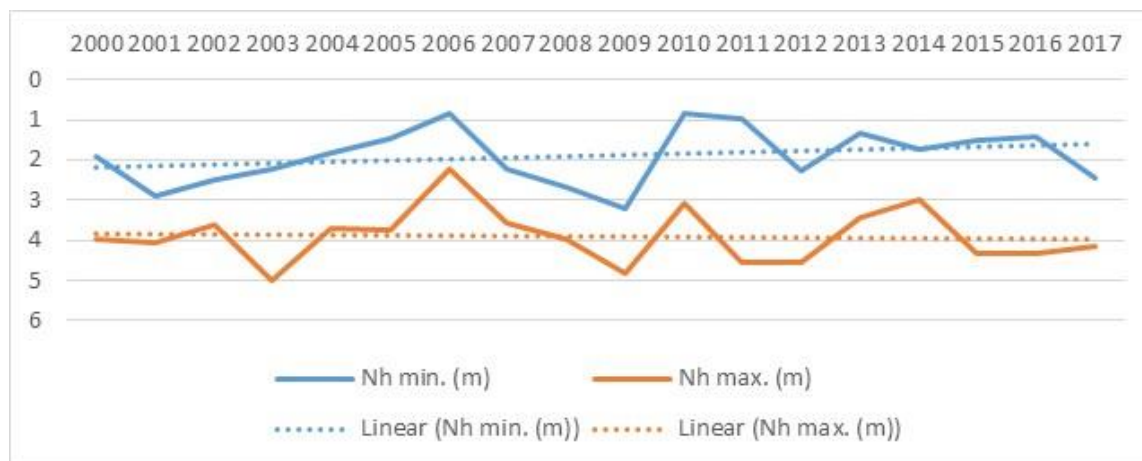
Figura 4.25 Variația adâncimii minime și maxime anuale a nivelului hidrostatic (m) măsurată față de cota terenului, în perioada 2000-2017 în forajul F1 Spanțov situat marginea sitului ROSCI0022, în interiorul acestuia, corpul de apă subterană ROIL11
