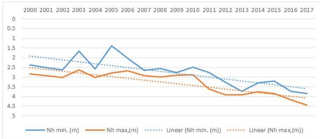
Figura 4.39 Variația adâncimii minimă și maximă anuală a nivelului hidrostatic (m) măsurată față de cota terenului, în perioada 2000 - 2017, în forajul F1 Stăncești situat în zona vestică a sitului ROSCI0290, corpul de apă subterană ROIL15
